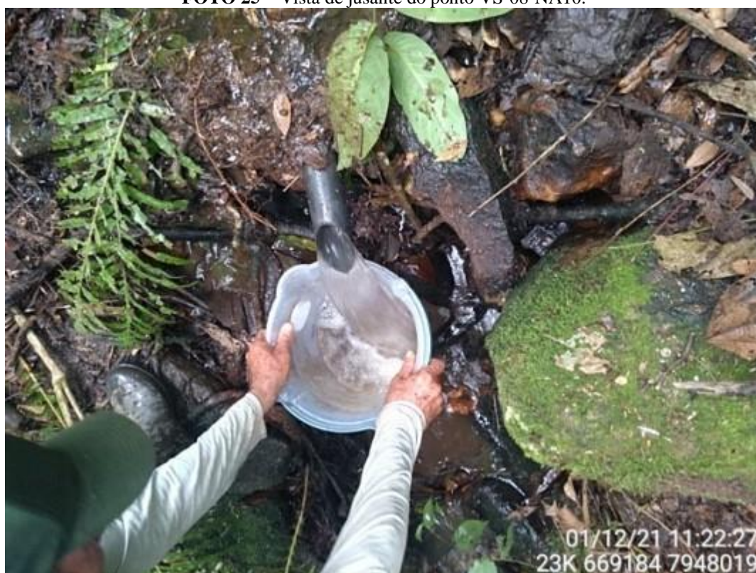
FOTO 26 – Vista da medição volumétrica no ponto VS-08-NA10.
